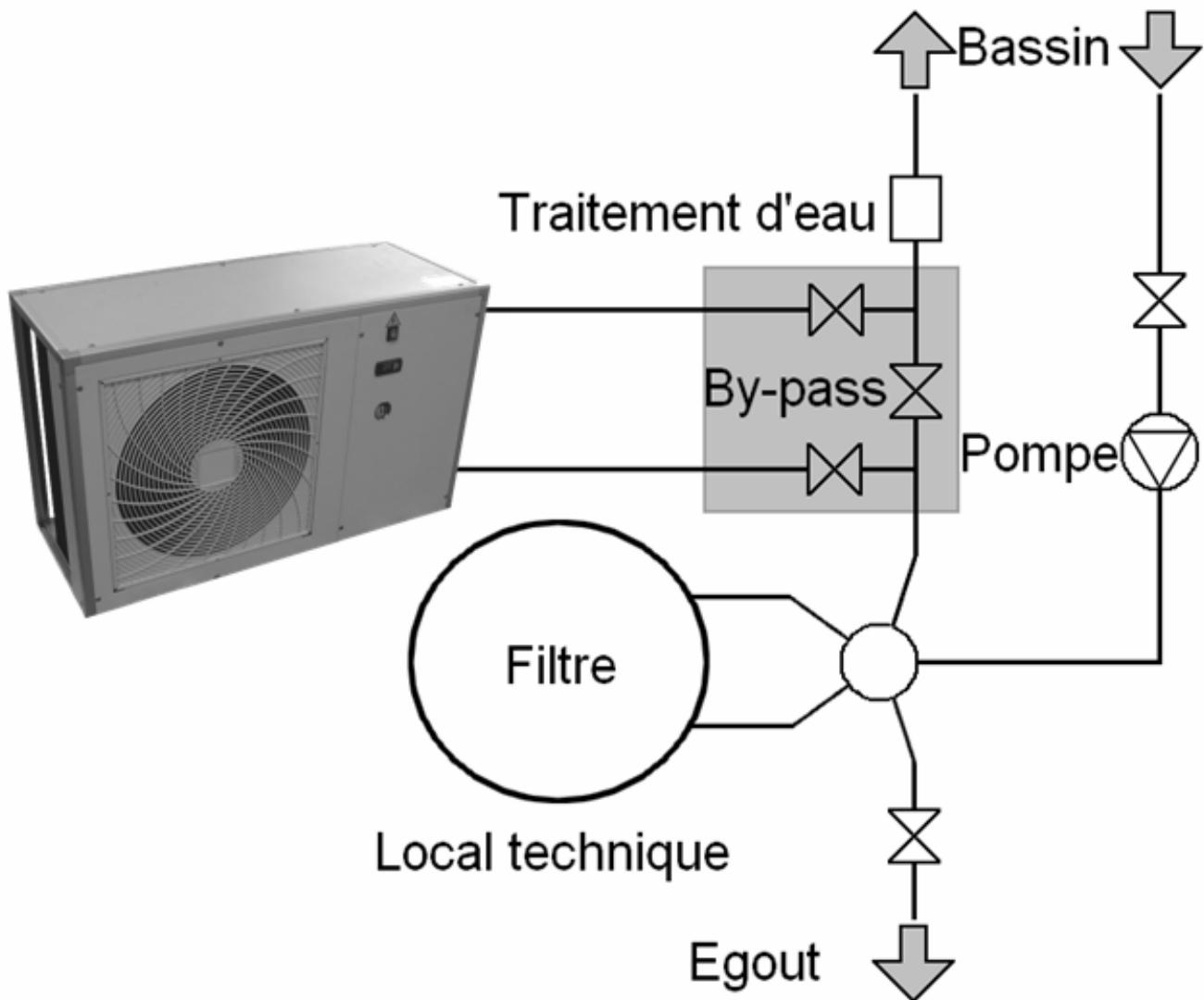
*Si votre installation est équipée avec un traitement avec adduction de produits (chlore, brome, sel, ...) le by-pass doit être installé avant le traitement de l'eau avec un clapet anti-retour entre le by-pass et le traitement d'eau.*
