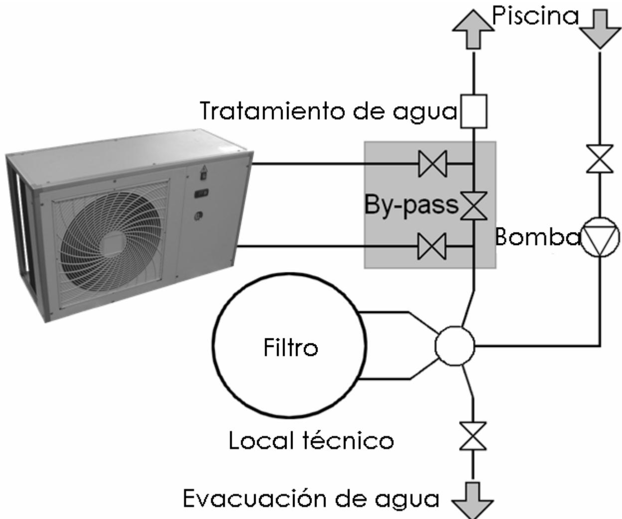
*Si vuestra instalación está equipada de un tratamiento de agua de productos (cloro, bromo, sal,...) el by-pass debe de estar instalado antes del tratamiento del agua con una válvula anti-retorno entre el by-pass y el tratamiento del agua.*
