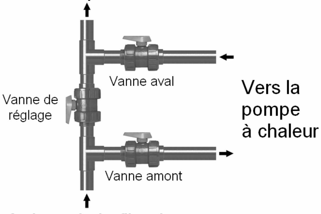
Attention, le by-pass doit impérativement être placé avec une fixation au mur ou un support de maintien, afin que le poids du by-pass et des tubes ne soit pas uniquement supporté par les connexions pompe à chaleur !
