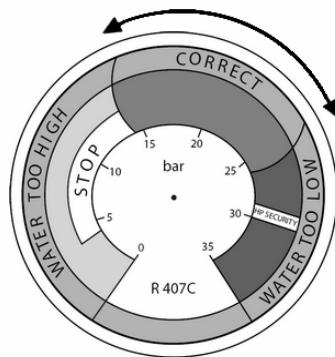
Para obtener un buen resultado del calentamiento y economizar energía, conviene regular el caudal del agua que pasa en la bomba de calor.
